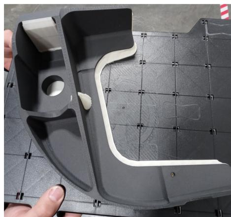
Strumento di controllo per aeromobili in Nylon-CF10 rinforzato con fibra di carbonio.
