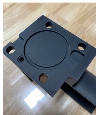
La flangia di montaggio del dispositivo di raccolta dei pezzi mostra la finitura di superficie che è possibile ottenere con il Nylon-CF10 FDM.
