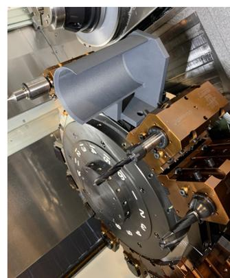
Il dispositivo di raccolta dei pezzi stampati in 3D (grigio) è fissato sulla torretta inferiore del tornio.
